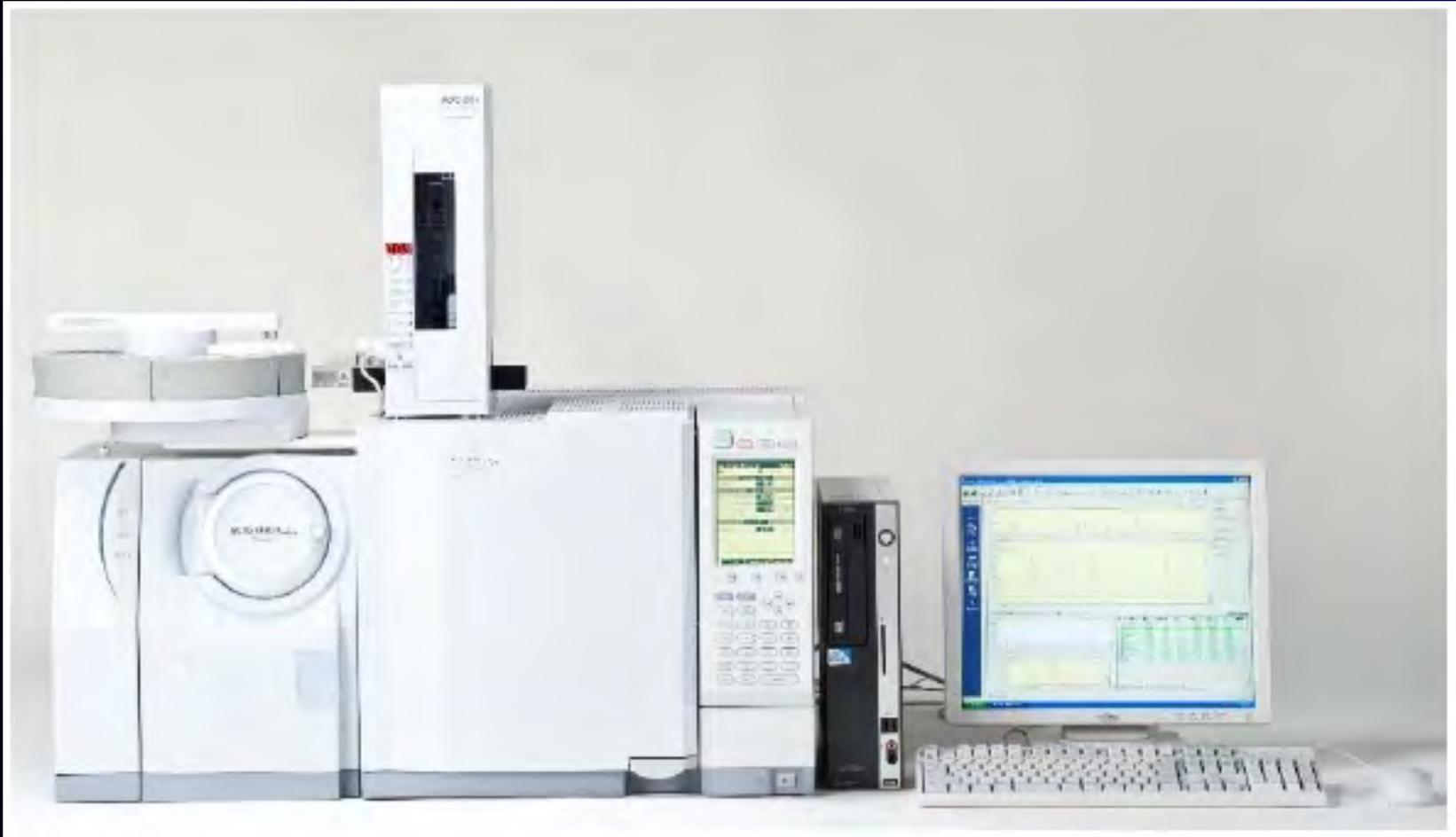
GCMS-System „QP2010Ultra“; Abb.: Fa. Shimadzu, 2010
